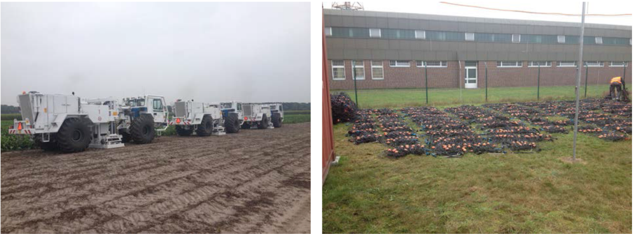
Fig. 1 - Sorgenti Vibroseis in azione e geofoni in fase di collaudo (foto Magma Energy Italia)
