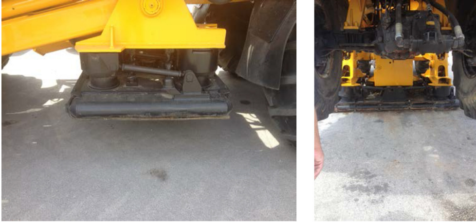
Fig. 6 - Dettaglio sulla piastra vibrante con protezione in gomma per prevenire danni al suolo stradale (foto Magma Energy Italia)
